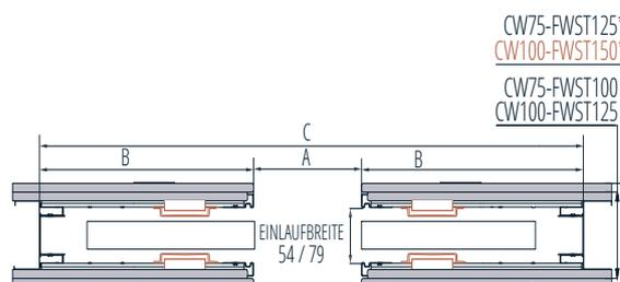
FWST = Fertigwandstärke | CW = Profilstärke | \* Doppelbeplankung | \* bei Kabelkanal vormontiert für FWST 150
