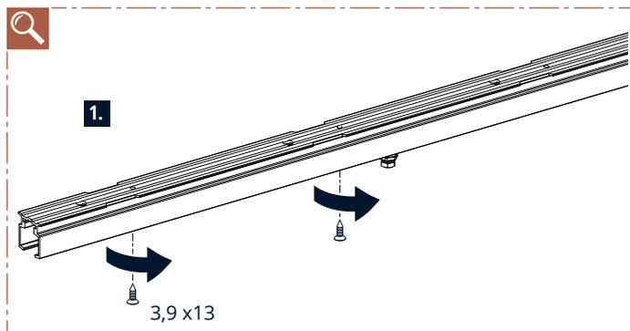
**!** Montieren Sie alle, der in Schritt 1 ausgebauten Schrauben!
